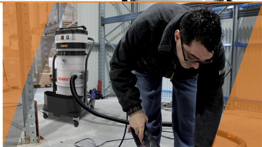
El modelo 350 ICLEAN es el aspirador monofásico de 3 motores por excelencia. Es el más apreciado por quienes lo utilizan en el trabajo diario, especialmente en el campo del tratamiento de superficies. Demuestra ser el aspirador monofásico más eficaz del mundo para la aspiración de polvo fino, procedente de máquinas en producción como las lijadoras.
